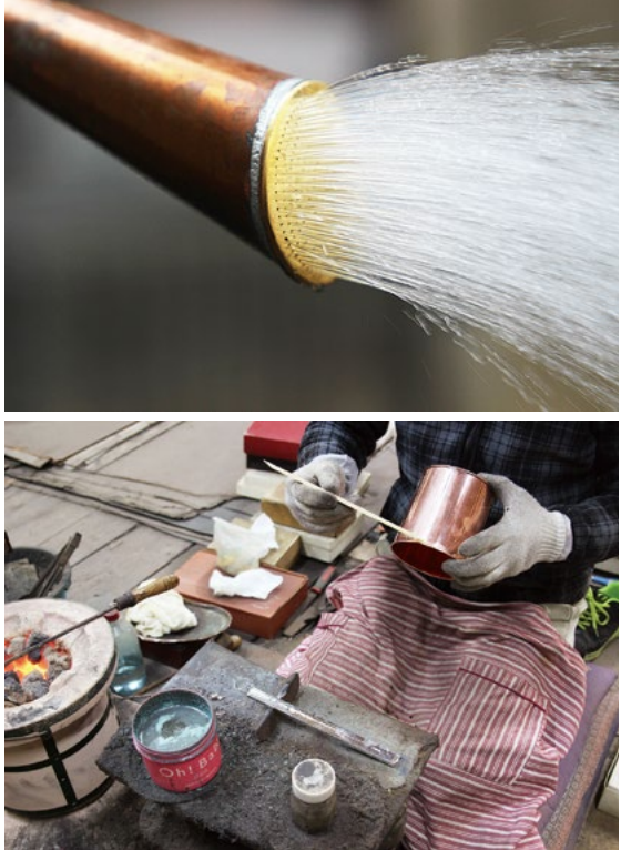
用途などに応じて20種以上の製品を取りそろえる(右)。蓮口の穴の数は200個以上(左上)。銅板の加工からハンダづけ、最終チェックまですべて手作業で行う(左下)
